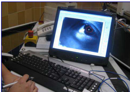
Kamery umożliwiają podgląd oka w czasie kontroli planu radioterapii oraz podczas sesji radioterapeutycznych
